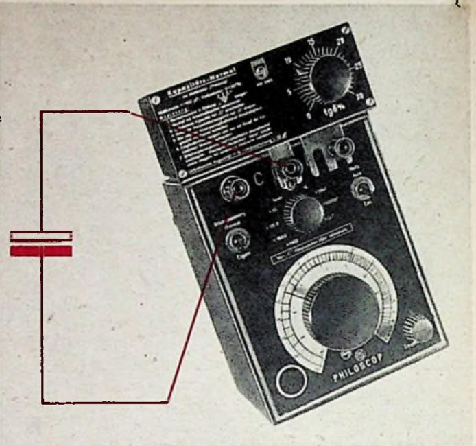
Philoscop-Meßbrücke mit angeschetztem Kapazitätsnormal zur Messung des  $\text{tg } \delta$ -Wertes von Elkos
